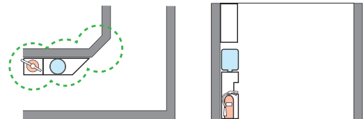
[권장] - 통행을 방해하지 않도록 매입식으로 설치, 또는 수납장과 통합설치된 식수대 및 소화기 - 사선으로 모따기한 벽 모퉁이
